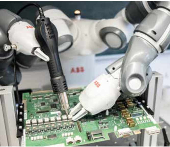
Entlöten von Bauteilen auf einer Platine mit dem ABB YuMi
