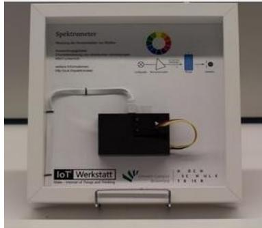
Eigenbau-Spektrometer, z. B. zur Analyse der Nitrit-Belastung in Wasserproben
