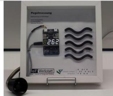
Demonstrator zur Ultraschall-Pegelmessung z. B. für Gewässer oder zur Überwachung von Kellerräumen
