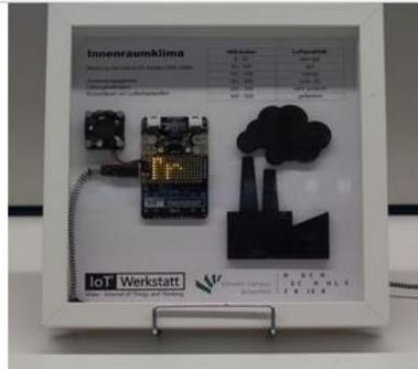
Demonstrator zur Erfassung des Innenraumklimas (Indoor Air Quality Index - IAQ) mit Abluft-Steuerung
