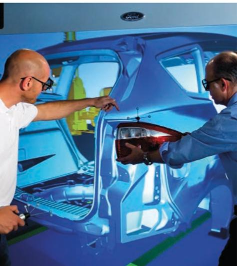
Abb. 1: Virtuelle Einbauuntersuchung
