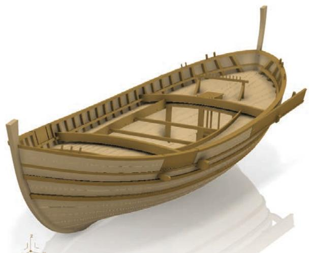
Abb. 9: Digitale 3D-Rekonstruktion des römischen Handelsschiffes Laurons II
