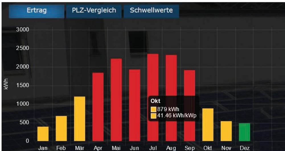
Abb. 2: Ertragsübersicht mit monatlicher Bewertung. Die Höhe der Balken repräsentiert den monatlichen Stromertrag der PV-Anlage, die Einfärbung spiegelt die Bewertung des Ertrags im Vergleich zu Referenzanlagen wider.
