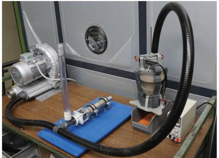
Abb. 6: Versuchsaufbau Granulat-Extruder und Förderung
