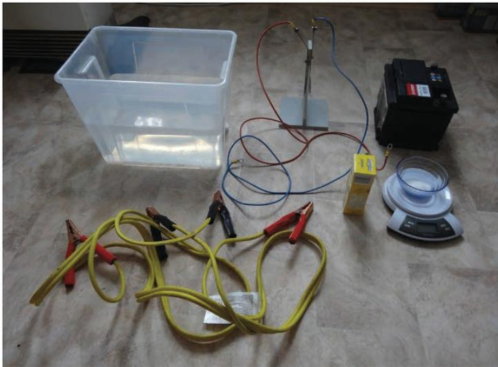
Abb. 1: Prototyp der Apparatur zur Chlorerzeugung (links: gesamtes Zubehör, rechts: Elektroden), Fotos aus [Luu, 2016]
