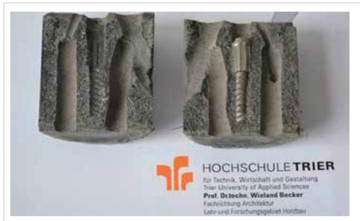
Abb. 6: Begleitende Materialversuche - Auszugsversuche Polymerbeton-Stahl
