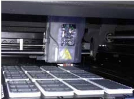
Abb. 4: 3D-Druck der Kunststoffgehäuse
