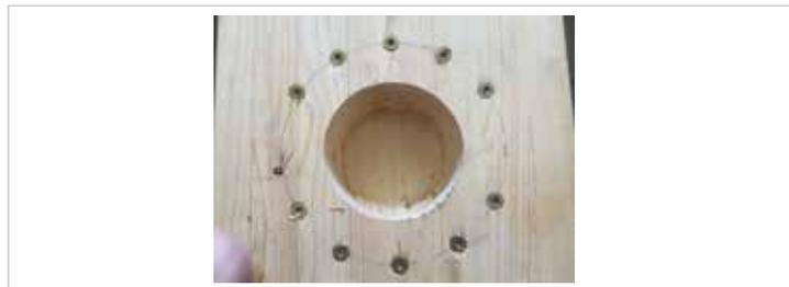
Abb. 7: Durchstanzversuche am Holzdeck
