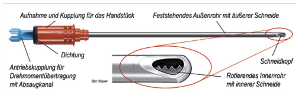
Abb. 1: Chirurgisches Shaver blade-Rotationsmesser und Schneidkopf – Typ „Aggressive Cutter“
