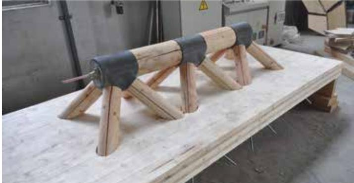
Abb. 8: Mittelteil des Brückentragwerkes während einer Erprobung
