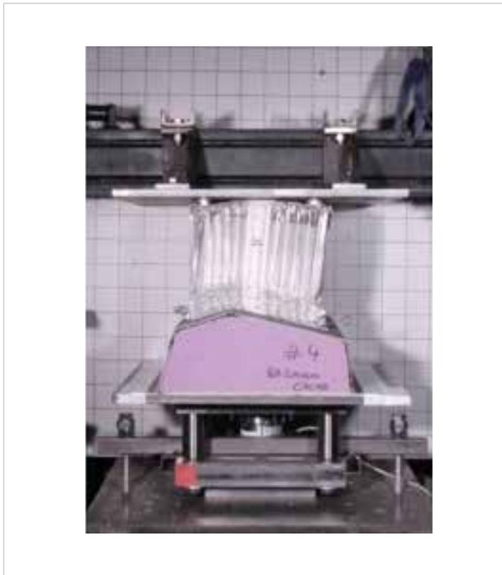
Abb. 6 : Crashversuch eines Schwellerabschnitts
