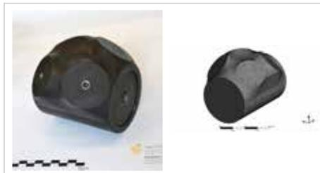
Abb. 4: Strukturmodell und fertiger Verbindungsknoten
