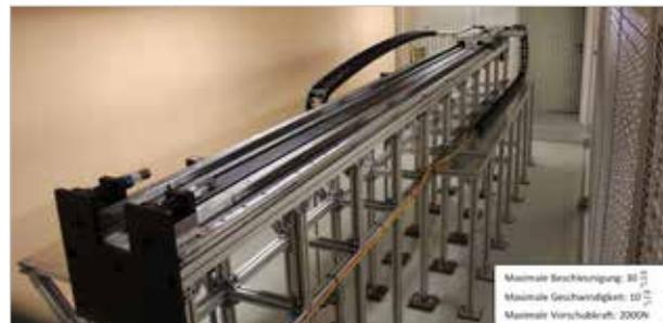
Abb. 2: Schleppkettenprüfanlage
