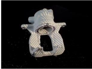
3D-Geometrieerfassung (Topografie) eines Bremssattels
