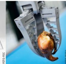
Die Polyamidfinger des bionischen Greifers von Festo: leicht dank Rapid Prototyping
