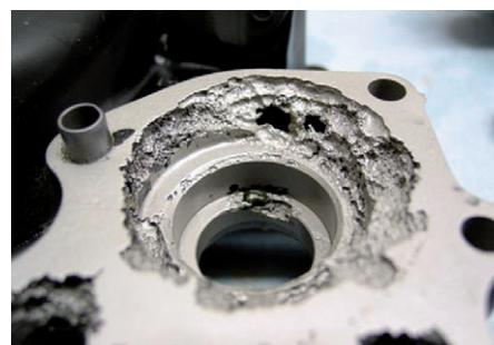
Galvanische Korrosion am Wasserpumpengehäuse
