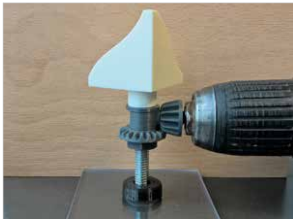
Abb. 9: Funktionsprototyp aus dem 3D-Druck: Winkelsteller für den Möbelbau
