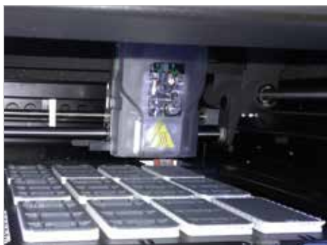
Abb. 4: 3D-Druck der Kunststoffgehäuse
