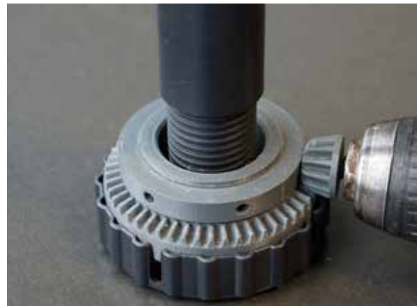
Abb. 10: Funktionsprototyp aus dem 3D-Druck: Winkelstellers zur Höhenverstellung von Möbelfüßen
