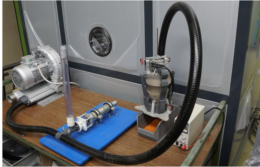
Abb. 6: Versuchsaufbau Granulat-Extruder und Förderung
