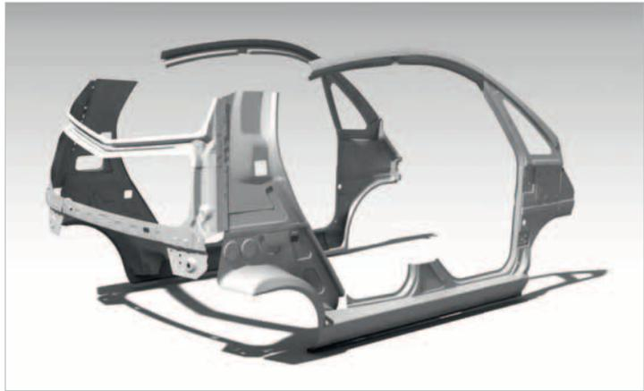
Abb. 6: 3D-Geometrie nach dem Reverse Engineering [2]
