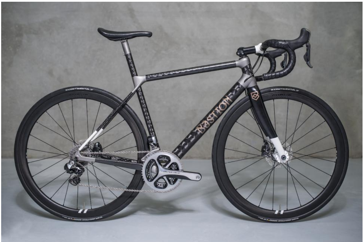
Abbildung 2 : Bastion Rennrad mit Kohlefaserrohren. Quelle www.Bastion-Cycles.com
