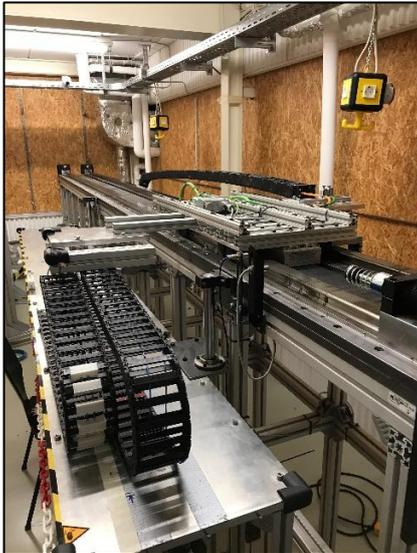
Abbildung 1: Schleppkettenanlage im LAP
