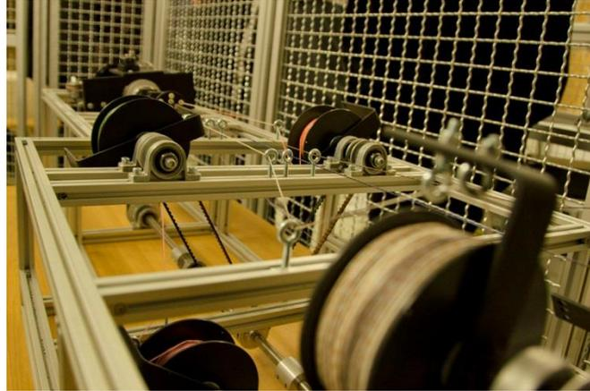
Bild 1: Patentiertes Modell für Kabelverseilung im Labor für angewandte Produktionstechnik
