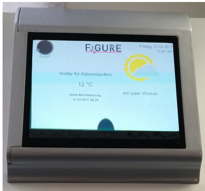
Abb. 2: FAL im Seniorenwohnheim. Das Feld zum Einlesen der Minutien befindet sich unten in der Mitte. Es werden Wetterdaten entsprechend dem Nutzerprofil dargestellt.
