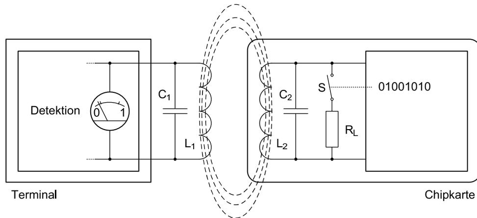
Abb. 2.11: Transformatorische Kopplung und Lastmodulation
