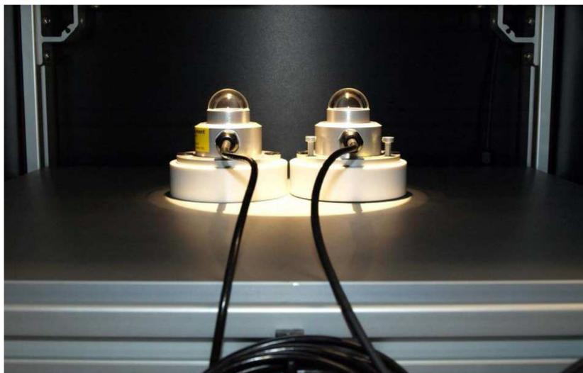
Abbildung 1: Kalibrierung eines Pyranometers zur Messung der globalen Strahlung (Quelle: hukseflux)
