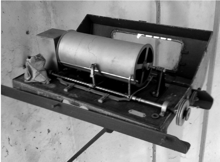
Abb. 2: Ehemalige Schreibpapierrolle zur Wasserstandsaufzeichnung im Pegelhäuschen Römerbrücke (Aufnahme vom 23.6.20).
