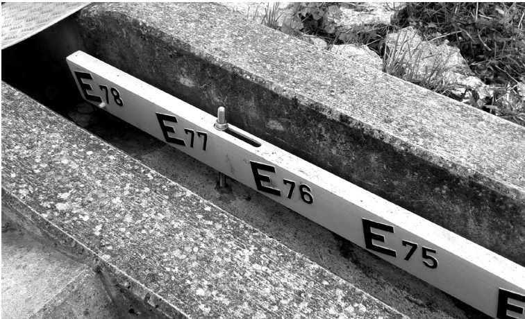
Abb. 9: Unterste Staffel längs der Treppe zur Mosel (sog. Treppenpegel) des neuen Pegels UP Trier (Aufnahme vom 23.6.20).
