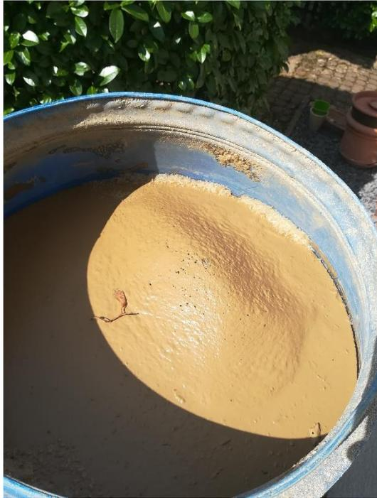
Abb. XXV Lehmablagerung, die den Filter wasserundurchlässig macht
