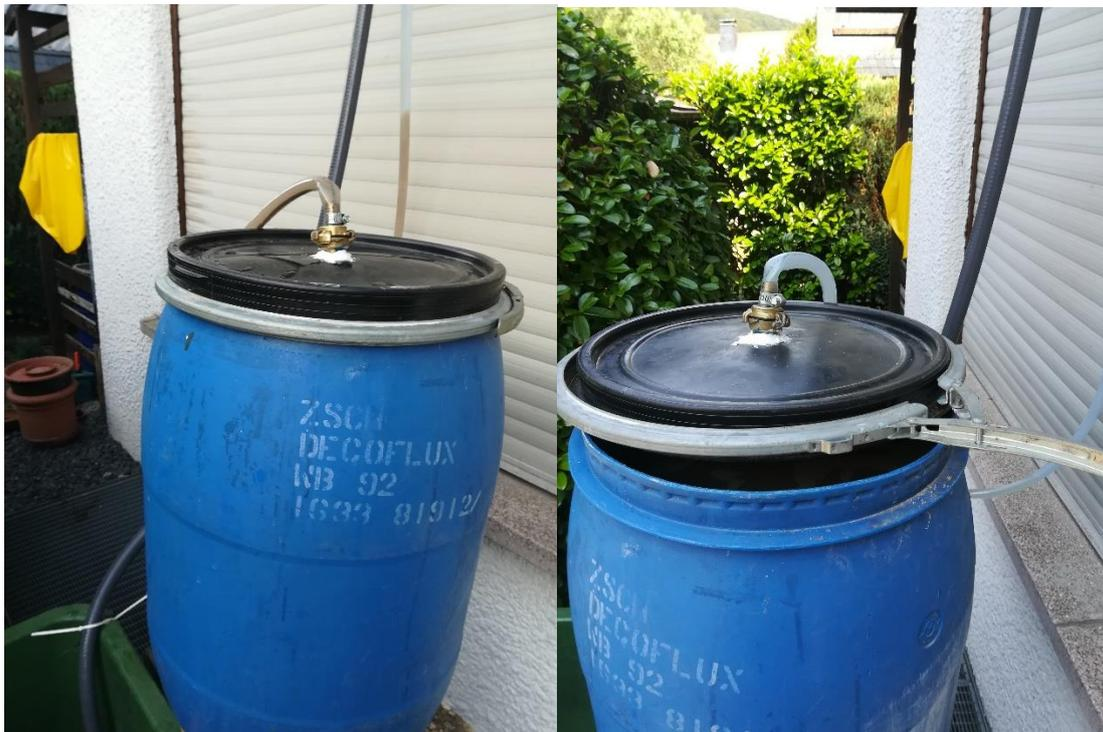
Abb. XXI Versuchsaufbau mit abgedichtetem Deckel
