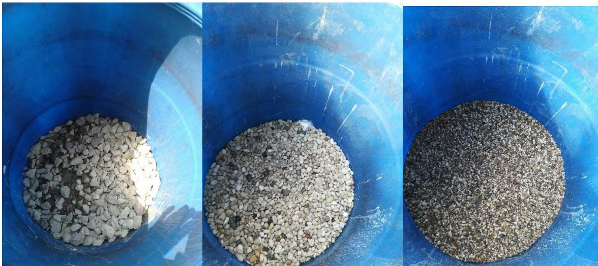
Abb. XVII Filterschichten Schotter 0/45 Kies 8/16 Splitt 2/5
