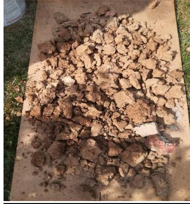
Abb. V der zerkleinerte, verwendete Lehm
