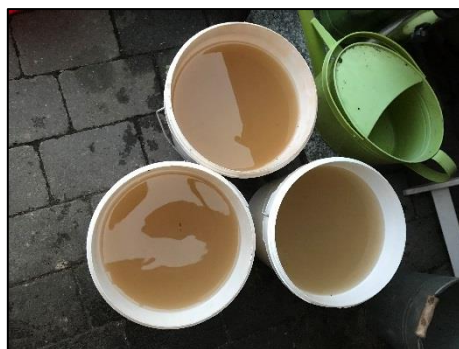
Abb. 11.1: Eimer gefüllt mit verschiedenen Lehm-Wasser-Gemischen; mit 5g, 10g, 20g Lehm
