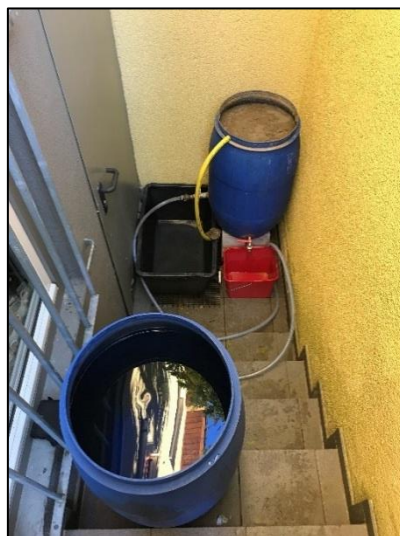
Abb. 15.1: Rückspülversuchsaufbau mit einer Wasserdruckhöhe von 77 cm
