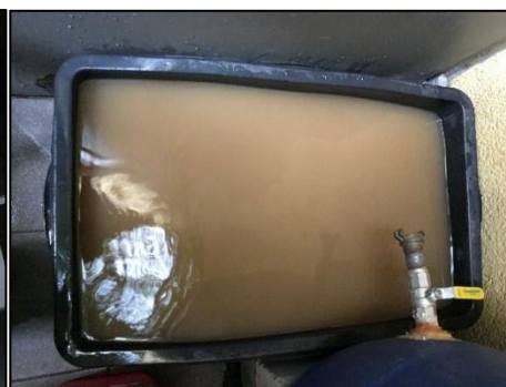
Abb. 11.2: Bütte gefüllt mit einem Lehm-Wasser-Gemisch; mit 200g Lehm
