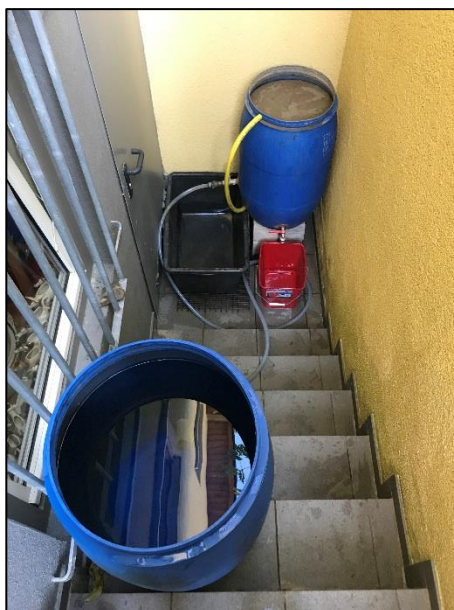
Abb. 16.1: Rückspülversuchsaufbau mit einer Wasserdruckhöhe von 95,5 cm
