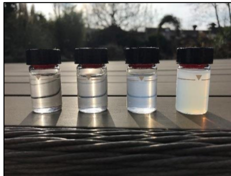
Abb. 3.1: Kalibrierflüssigkeiten mit Formazin, 0.02 NTU, 20.0 NTU, 100 NTU, 800 NTU
