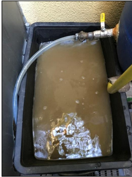
Abb. 16.3: Lehm-Wasser-Gemisch aus Rückspülablauf mit 676 NTU
