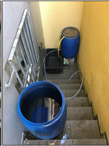
Abb. 14.4: Rückspülversuchsaufbau mit einer Wasserdruckhöhe von 114 cm
