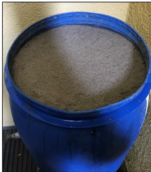
Abb. 9.1: Filtertonne aufgefüllt mit Quarzsand 0/1 mm
