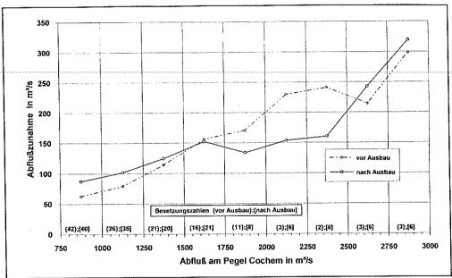
Abb.2: Abflußzunahme der Hochwasserscheitel zwischen Trier und Cochem [6]
