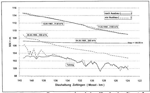
Abb. 16: Wasserspiegellagen vor und nach dem Moselausbau Staustufe Zeltingen [ 6 ]
