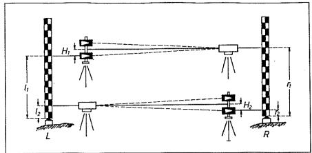
Abb.11: Anordnung der Instrumente bei der Stromübergangsmessung [4]
