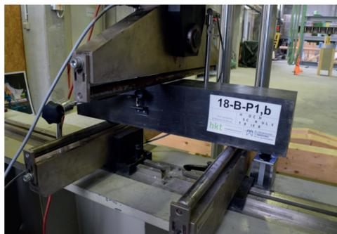
Abb. 5 3-Punkt-Biegezugversuch
