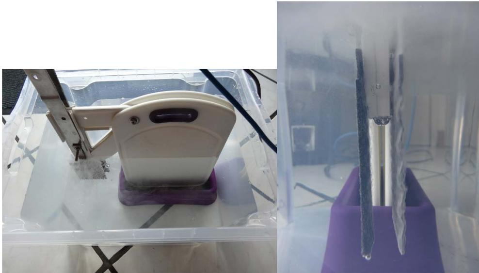
Abb. 4.11: Produktion von Chlor und Prozess der Elektrolyse
