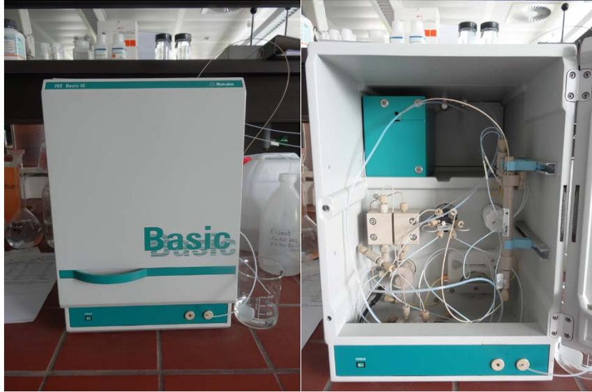
Abb. 5.10: Ionenchromatograph (links: Ionenchromatograph geschlossen, rechts: Ionenchromatograph geöffnet)
