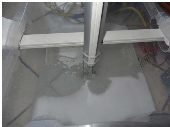
Abb. 4.15: Aluminium als Elektrodenmaterial
