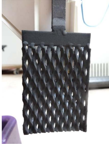
Abb. 4.4: Titananode mit Bleidioxid-Beschichtung
