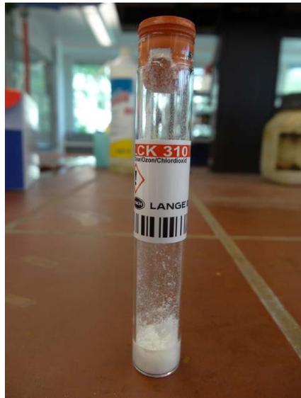
Abb. 5.3: Küvette mit Inhaltsstoff Diethyl-p-phenylendiamin
