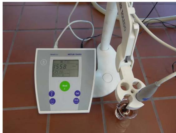
Abb. 5.9: Leitfähigkeitsmessgerät
