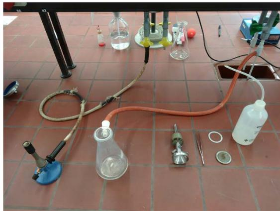
Abb. 5.11: Gesamtaufbau der Arbeitsmaterialien des Membranfilter-Verfahren (fehlend: 100-ml-Gefäß (vom zu untersuchenden Wasser), NKS in Petrischale, Membranfilter und Brutschrank)
