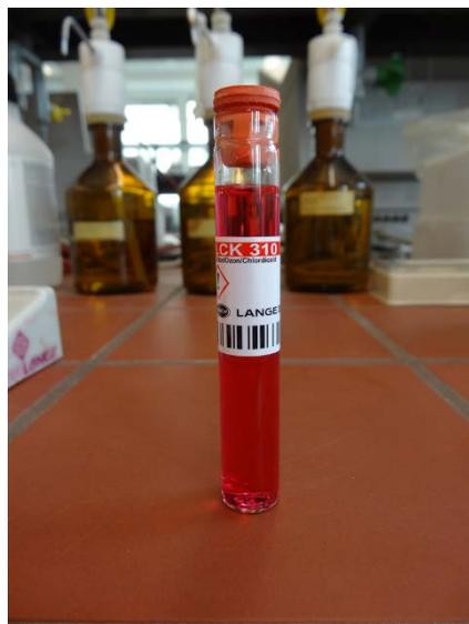
Abb. 5.7: Chlor reagiert mit Diethyl-p-phenylendiamin (DPD) unter Bildung eines roten Farbstoffes
