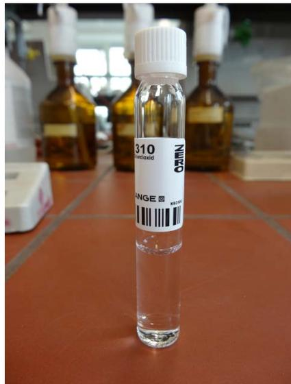
Abb. 5.5: „Null“-Küvette für Null-Eichung des Digital-Photometer
